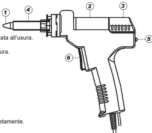
1) **Ugello:** Trasmette calore per la dissaldatura, è una parte destinata all'usura.
